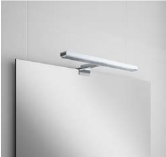
Aplique MINERVA 280 luz led (6 W.) sujeción multienganche IP 44 280 x 27 x 110 mm 15707
